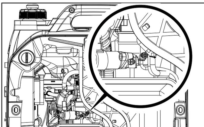
6. Cuando la gasolina pare de fluir del tubo transparente, gire el tornillo de drenaje a reloj (derecha) hasta que se apriete. Deshágase de la gasolina drenada en acuerdo con las regulaciones y normas locales.
