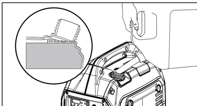
3. El nivel de combustible aproximado se muestra en el medidor de combustible en la parte superior del tanque de combustible.
