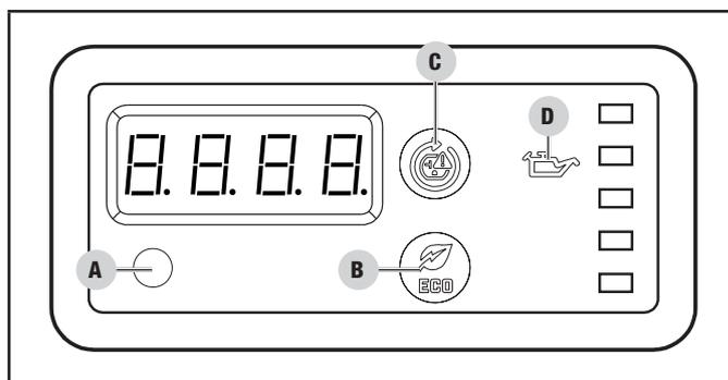
C. **Botón de restablecimiento de sobrecarga CA** – Utilizado para dar energía de nuevo a los receptáculos después de falla de sobrecarga.
