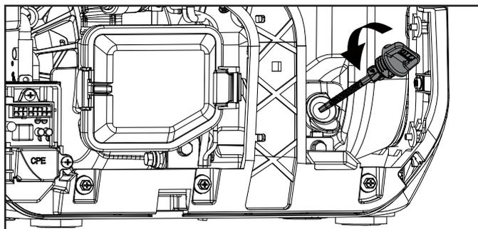
4. Incline el generador a un costado y permita que el aceite drene completamente.
