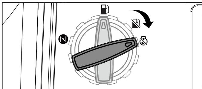
**Importante:** Siempre asegúrese de que el dial EZ Start y la palanca de ventilación de combustible en la tapa de combustible estén en posición "APAGADO" cuando el generador no esté en funcionamiento.
